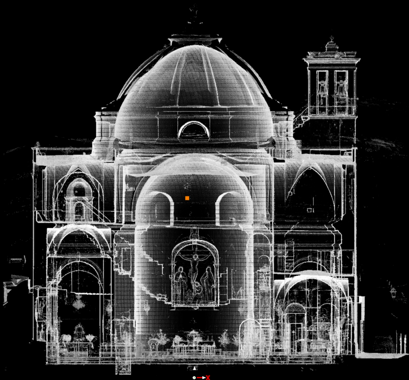
sezione trasversale della nuvola di punti cross-section of the point cloud
